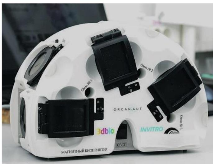
Рисунок 5.2.2 - Внешний вид магнитного биопринтера
