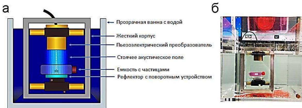
Рисунок 4.4.2 – Акустическая установка: а) схема экспериментальной установки; б) фотография экспериментальной установки
